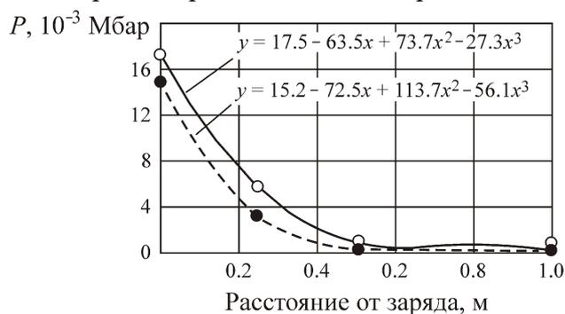
Рис. 4. Изменение первого инварианта тензора напряжений, создаваемых взрывом заряда АС/ДТ-6 диаметром 115 мм (сплошная линия) и 80 мм (пунктирная линия) с расстоянием от заряда
