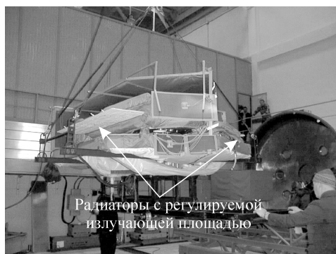
Рис. 8. Каретки фокальных приборов телескопа «Спектр-РГ» с регулируемыми радиаторами.
