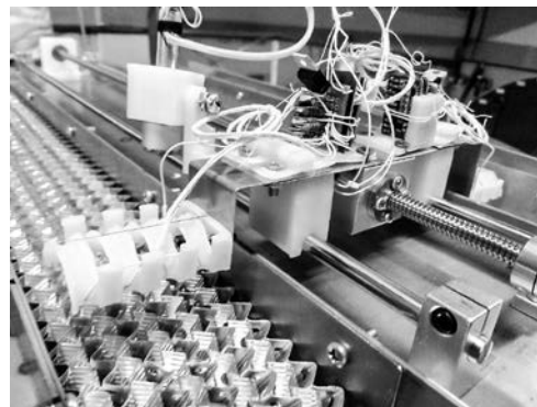
Рис. 3. Фотография конструкции координатного устройства с размещенным на нем многоточечным измерителем-анемометром.
