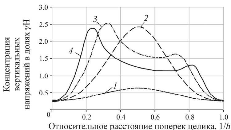
Рис. 5. Распределение концентрации вертикальных напряжений в целике между выработками в зависимости от ширины целика: 1 — при m = 1 ; 2 — m = 2 ; 3 — m = 3 ; 4 — m = 4
