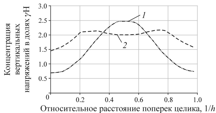
Рис. 3. Распределение концентрации вертикальных напряжений в целике между камерами в зависимости от параметров объемной прочности пород вмещающего массива: 1 — упруго-пластическое решение, сцепление 5 МПа; 2 — упруго-пластическое решение, сцепление 10 МПа
