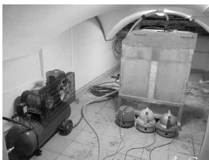
Рис. 3. Экспериментальная установка на базе бункера пылеподавления БПП № 001
