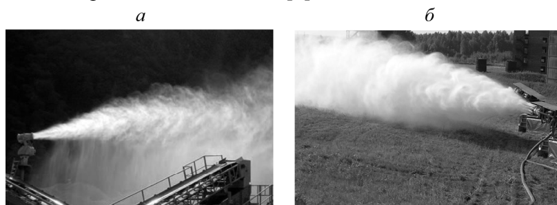
Рис. 1. Аэрозольная пушка-туманообразователь для пылеподавления: а — в режиме осаждения пыли в воздухе; б — в режиме увлажнения поверхности за счет “стелющего” эффекта
