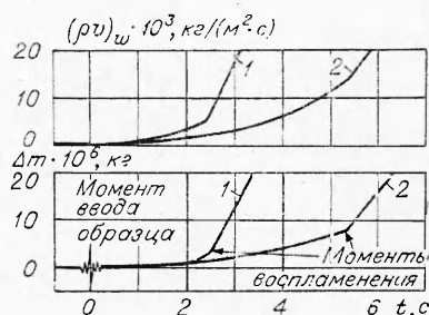
Рис. 1. Изменение массы образца ПММА и скорости массового уноса во времени в набегающем потоке кислорода при C_e=0,98 ; \beta \approx 300 с ^{-1} и температурах газа 1140(1) и 1110 К (2).
