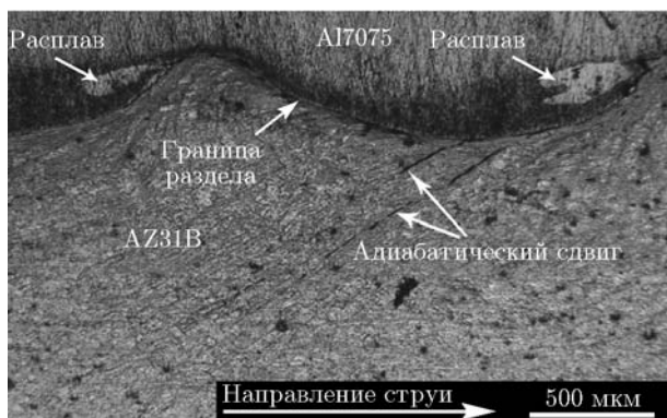
Рис. 21. Микроструктура зоны соединения композита AZ31B/Al7075 [35]
