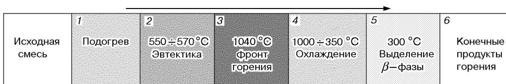
Рис. 4. Схема последовательных превращений в образце состава 3Cu—Al при его косвенном подогреве, фронтальном горении и охлаждении: условно представлена в горизонтальном положении, в действительности тепловая волна перемещается снизу вверх
