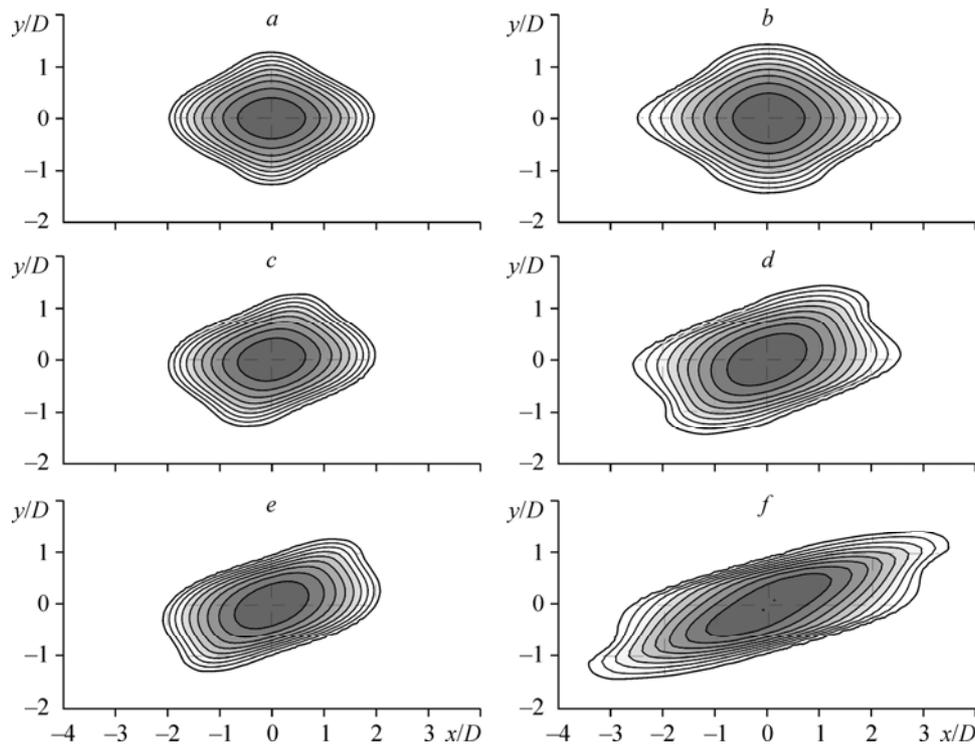
Рис. 2. Изолинии энергии турбулентности  $e(t, x, y)/e(t, 0, 0) = \text{const}$  в линейно стратифицированной среде в зависимости от сдвига скорости при  $t/T = 1$  (слева) и  $t/T = 2$  (справа).
