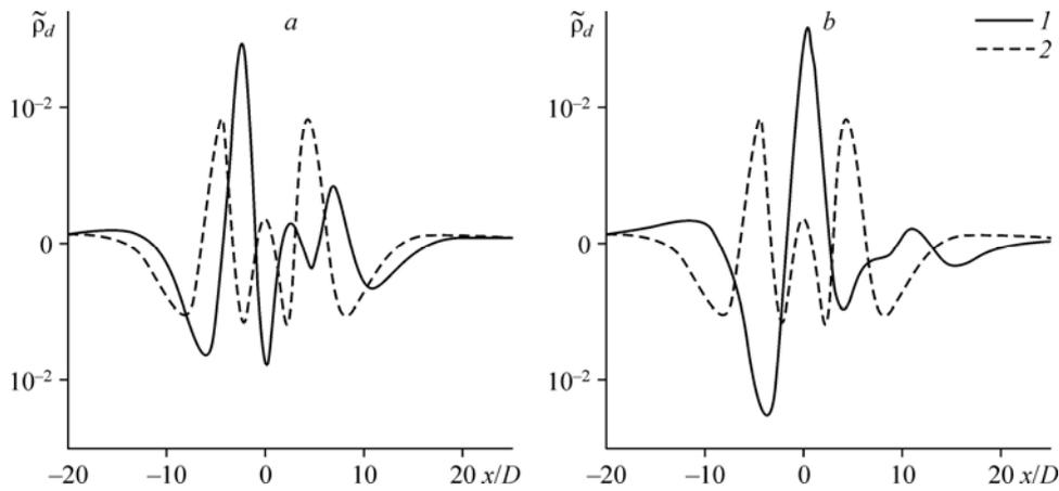
Рис. 7. Изменение дефекта плотности  $\tilde{\rho}_d(x^*) = \langle \rho_d(2, x^*, 4) \rangle^*$  в характерном сечении плоскостью  $y^* = 4$  в зависимости от сдвига скорости.
