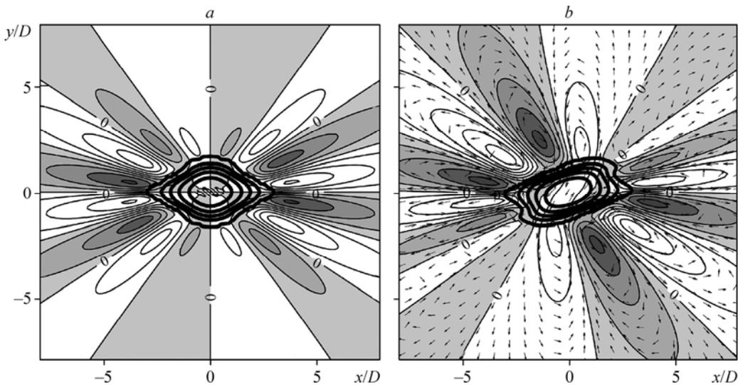
Рис. 4. Общая картина течения в следе в отсутствие сдвига скорости (а) и при наличии фонового сдвига скорости при  $\alpha = 10^{-3}$  (б).
