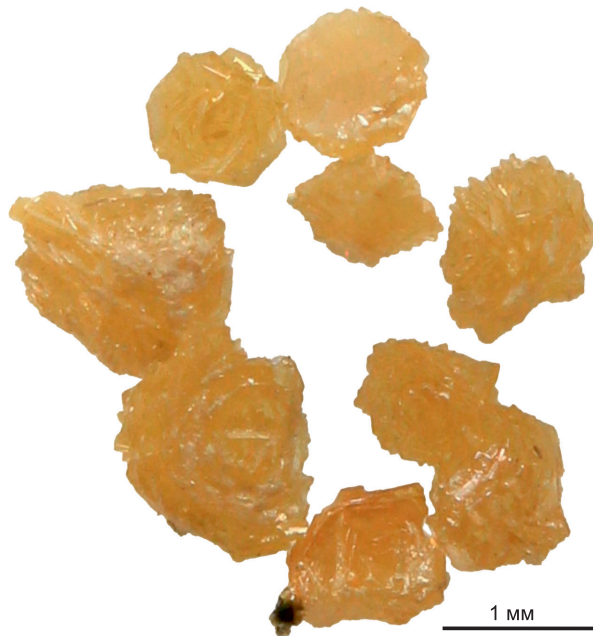
Рис. 4. Сферолитоподобные агрегаты сфалерита, полученные в системе с Sn (оп. 5).
