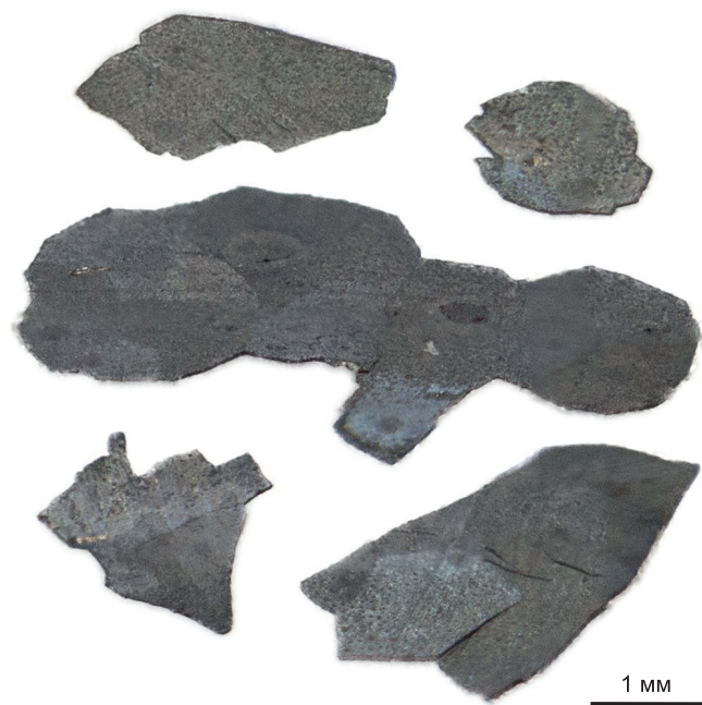
Рис. 2. Пластинчатые кристаллы (\text{Ag, Au})_2\text{S} с окисленной поверхностью, полученные в ассоциации со сфалеритом (оп. 2).
