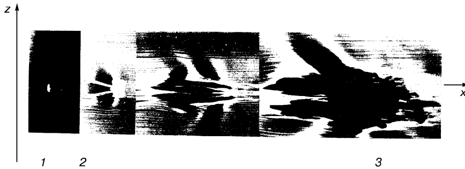
Рис. 2. Картина визуализации процесса трансформации \Lambda -вихря в турбулентное пятно [13].
