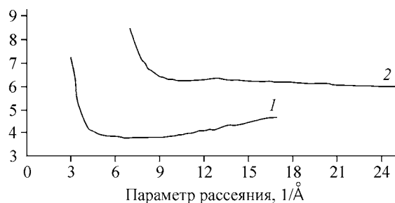
Рис. 3. Определенные в работе секторные функции. Кривая (1) в диапазоне 3—17 Å -1 соответствует длинному расстоянию сопло—пластинка (362,25 мм), кривая (2) 7—25 Å -1 — короткому (193,94 мм). Кривые умножены на атомную функцию рассеяния C 2 Cl 6
