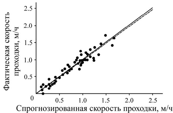
Рис. 5. Корреляция фактической скорости проходки ТПК с 80 резцами в условиях крайне твердой породы и спрогнозированной по уравнению (2)
