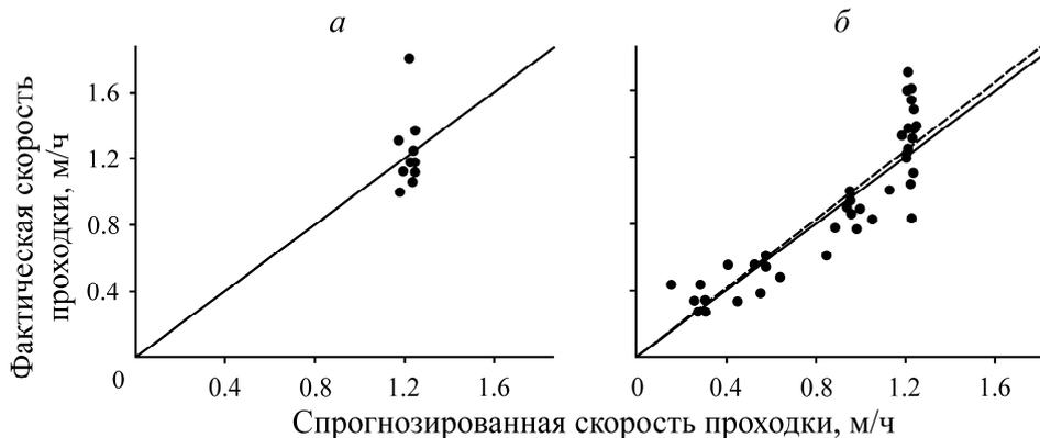
Рис. 8. Корреляция фактической скорости проходки и спрогнозированной по уравнению (2) для экспериментов 12 (а) и 15 (б) из таблицы
