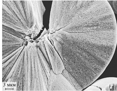
Рис. 5. SEM-фотография скола сферической частицы \text{TiO}_2 исходного порошка.
