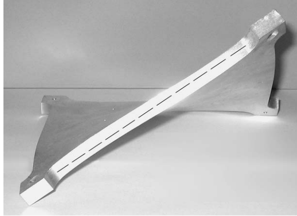
Рис. 5. Форма пластины из сплава 1163Т после деформирования в течение 3 ч
