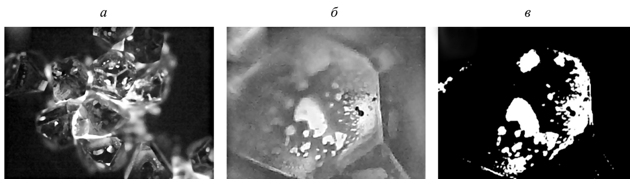
Рис. 2. Изображения агломерата алмаза с люминофорсодержащей фазой (а), подсушенного кристалла обработанного алмаза (б) и распределения люминофора на поверхности обработанного кристалла алмаза (в)
