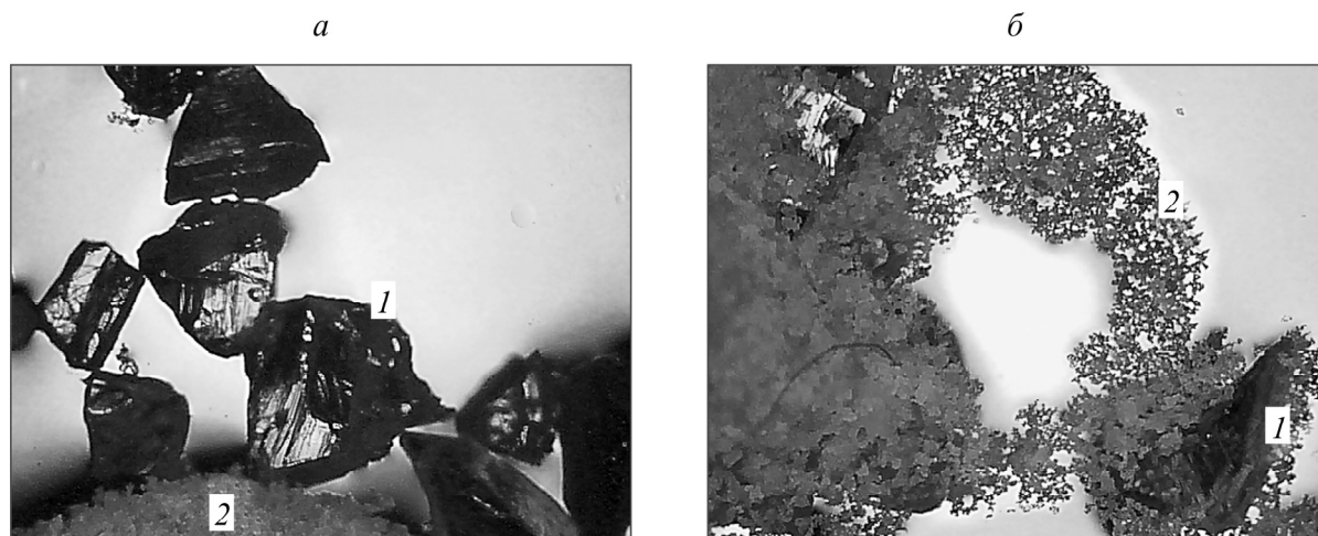
Рис. 1. Алмазы (1) и люминофорсодержащая композиция (2) в начале (а) и в конце (б) гидрофобного взаимодействия
