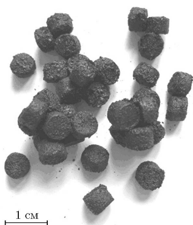
Рис. 3. Твердые продукты горения гранулированной смеси 40 % НЦ, 40 % \text{CoCO}_3 , 20 % ПИ
