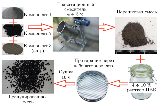
Рис. 3. Схема процесса получения гранулированной смеси из исходных порошковых компонентов
