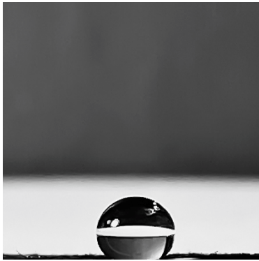
Рис. 4. Капля дистиллированной воды на поверхности из алюминия с продавленной текстурой и слоем наночастиц.
