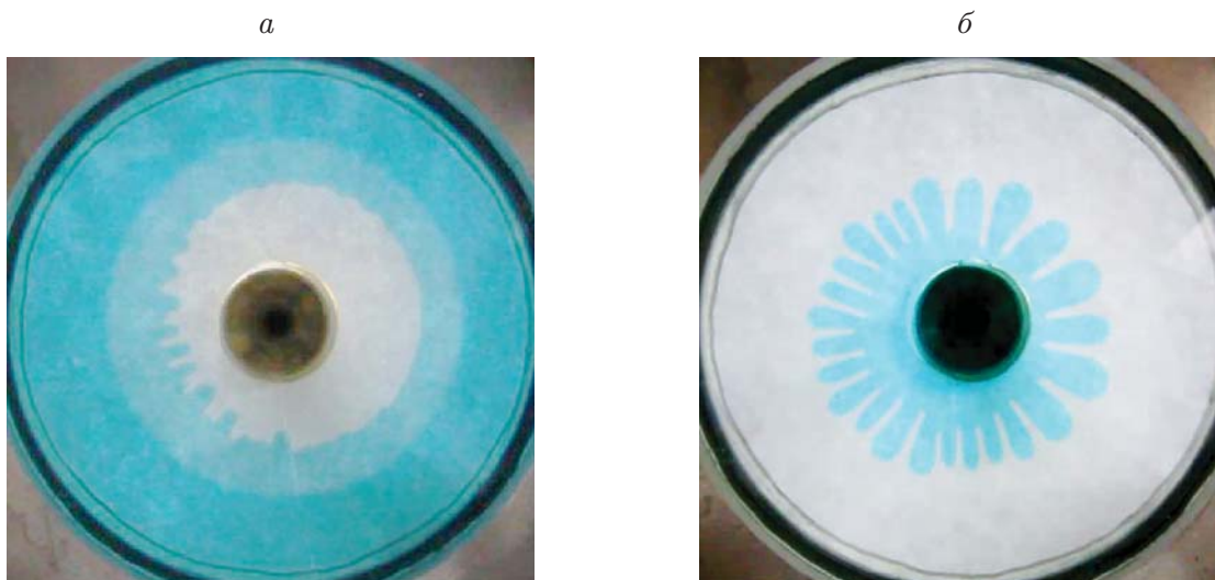
Рис. 2. Формы границы раздела в случае больших амплитуд колебаний для пары подкрашенная вода — ПМС-1000 при h = 1,70 мм, f_{vib} = 2 Гц: а — инвертированный случай, б — традиционная постановка
