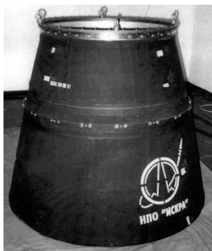
проводилась на полноразмерных насадках в штатной комплектации (рис. 3 и 4). Для расчетной оценки работоспособности материала насадка в условиях циклических нагрузок проведены дополнительные исследования характеристик усталости и трещиностойкости, а для определения аэродинамической устойчивости насадка в условиях истечения сверхзвуковой струи определен логарифмический декремент колебаний материала. Такой объем работ
