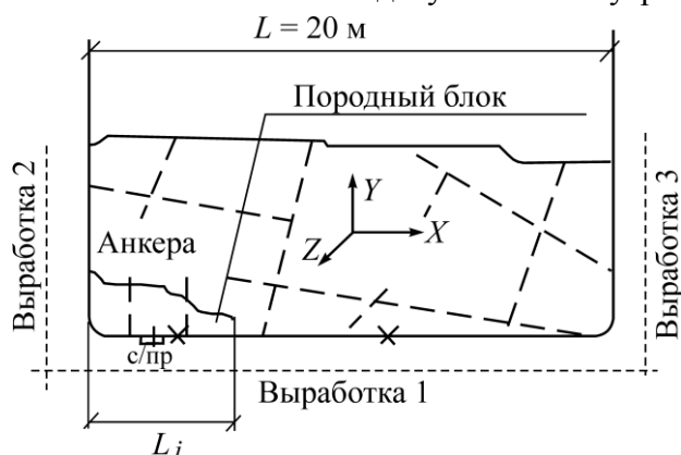
Рис. 5. План-схема натурального эксперимента: с/пр — 3-компонентный сейсмоприемник; X — точки возбуждения сейсмоколебаний
