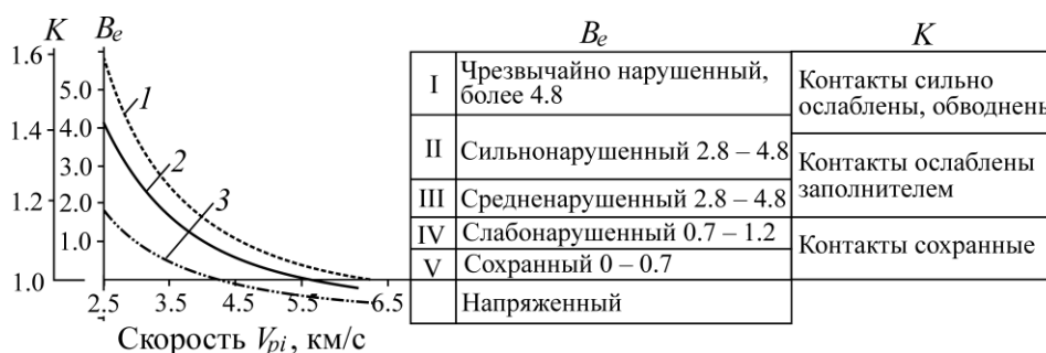
Рис. 3. Номограмма оценки состояния массива пород по геофизическим показателям B_e и K : 1 — V_{p0} = 6.5 км/с; 2 — V_{p0} = 5.7 км/с; 3 — V_{p0} = 4.2 км/с
