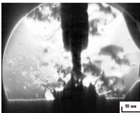
Рис. 4. Шлирен-фотография области газового разряда (темный цвет — ударные волны, белый — волны разрежения)
