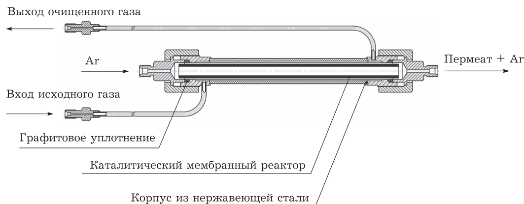
Рис. 3. Обечайка из нержавеющей стали с каталитическим мембранным реактором для разложения H_2S .
