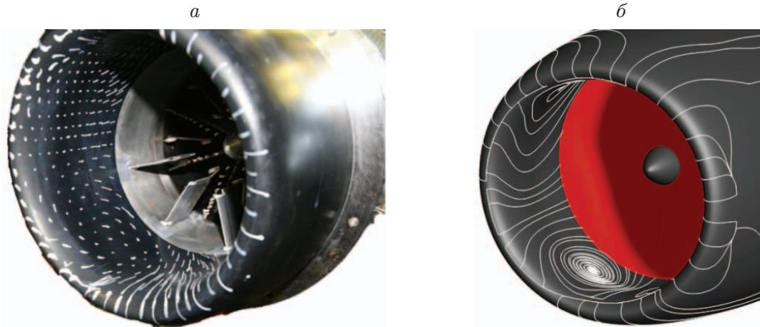
Рис. 6. Предельные линии тока на поверхности модели при  $V_s = 12$  м/с,  $q(\lambda) = 0,4$ :  $a$  — эксперимент,  $b$  — расчет
