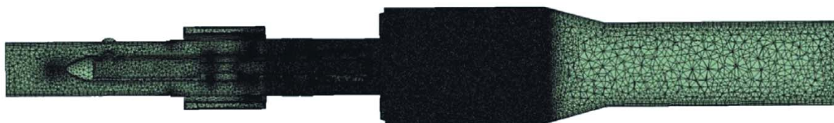
Рис. 2. Сеточная модель камеры сгорания с жаровой трубой
