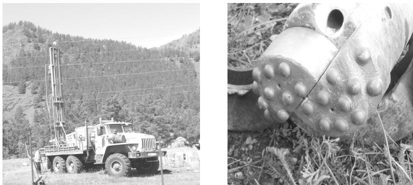
Рис. 2. Место испытаний (а) и инструмент для бурения скважин с их одновременной обсадкой на воду (б)
