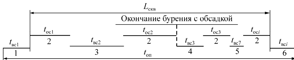
Рис. 5. Циклограмма бурения скважины на воду с одновременной обсадкой: L_{скв} — глубина скважины; t_{ос} — время основных операций (время бурения); t_{вс} — время вспомогательных операций; t_{оп} — оперативное время; 1–6 — участки
