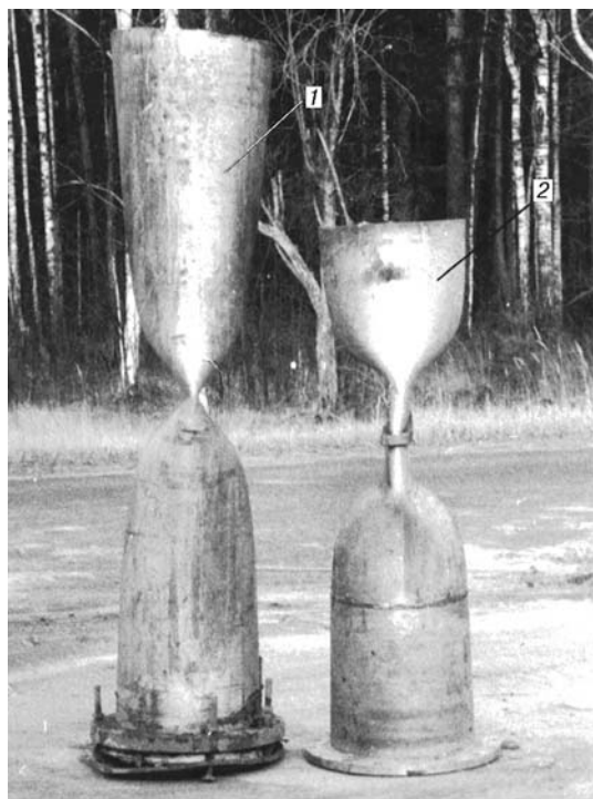
Рис. 4. Фотографии труб ( \varnothing 424 \times 12 мм) после нагружения ударниками:
