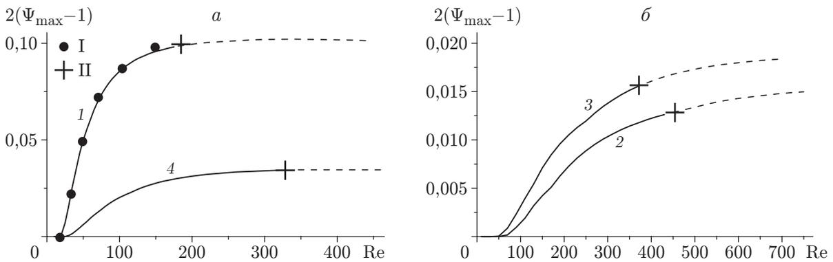
Рис. 4. Зависимость максимального значения функции тока  $\Psi(x^*, y^*)$  в зоне рециркуляции от числа Рейнольдса для течения в канале с двумя гофрированными стенками (1–3) и с одной гофрированной стенкой (4):
