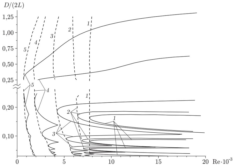
Рис. 5. Устойчивость течения в канале с одной гофрированной стенкой относительно двумерных возмущений ( $Q_z = 0$ ):
