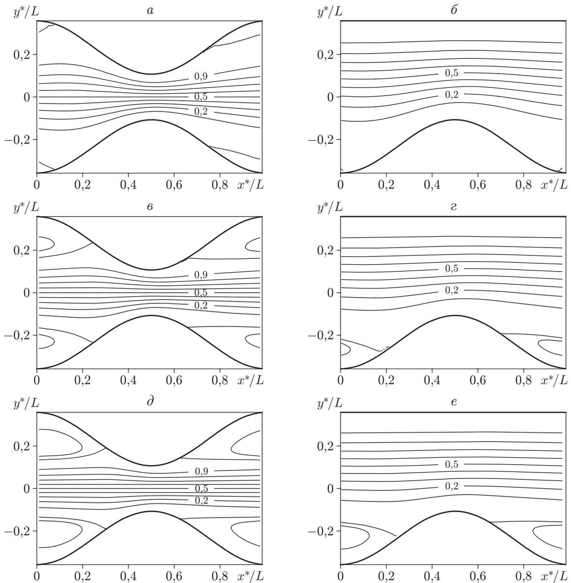
Рис. 3. Изолинии для функции тока основного течения  $\Psi(x^*, y^*)$  в канале с двумя гофрированными стенками (*a*, *в*, *д*) и с одной гофрированной стенкой (*б*, *з*, *е*) при  $\varepsilon_1 = 2A/D = 0,7013$ ,  $\varepsilon = D/(2L) = 0,35814$ :
