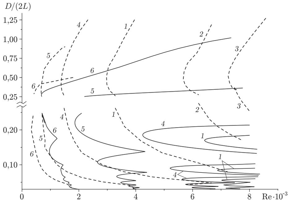
Рис. 6. Устойчивость течения в канале с одной гофрированной стенкой относительно трехмерных возмущений ( $Q_z \neq 0$ ,  $Q = 0$ ):
