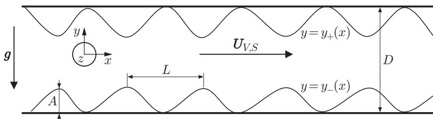
Рис. 1. Схема течения Пуазейля между двумя гофрированными поверхностями
