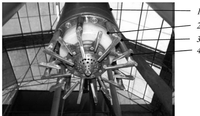
Рис. 1. Общий вид бурового наконечника диаметром 360 мм: 1 — буровой снаряд; 2 — высоковольтный проходной изолятор; 3 — заземленный электрод; 4 — высоковольтный электрод
