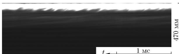
Рис. 3. Фрагмент фоторегистрограммы процесса дозвукового горения двухфазной смеси керосин — холодный воздух:
