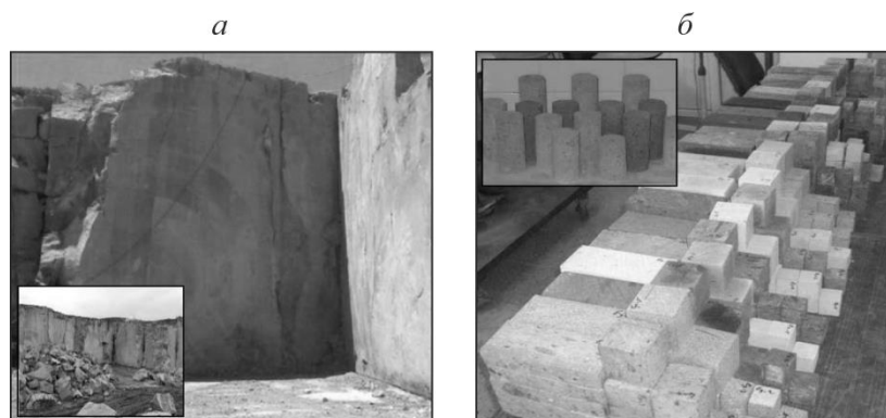
Рис. 1. Карьер строительного камня (а) и образцы туфа (б)
