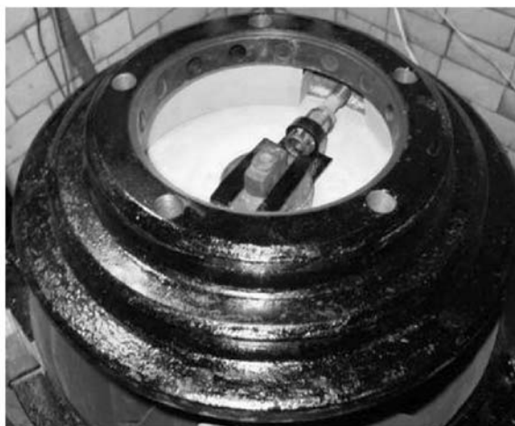
Рис. 2. Камера сжигания установки для исследования подводного горения унитарных твердых топлив в поле центробежных сил
