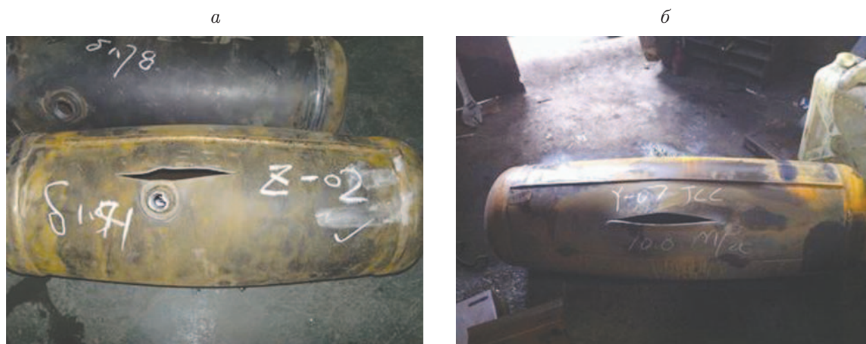
Рис. 8. Разрушенные сосуд 1 (а) и сосуд 2 (б)
