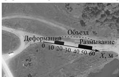
Рис. 3. Положение сейсмического профиля и проблемных участков дороги на местности
