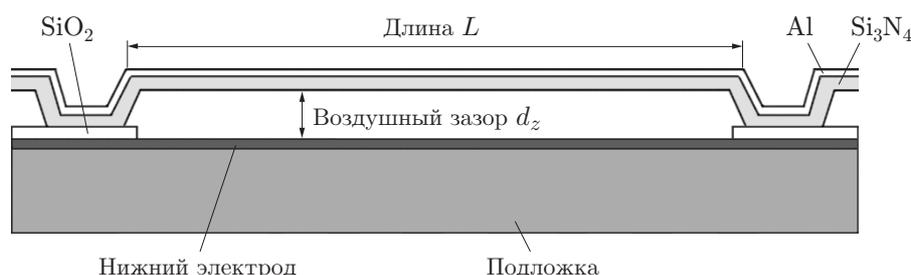
Рис. 7. Пример конструкции элемента GLV
