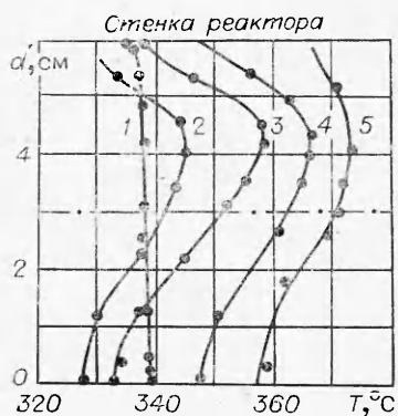
Рис. 2. Температурные профили по вертикальной оси реактора. 1 — инертная смесь; 2 — 5 — холодные пламена при T_{ст} реактора, равных соответственно 327, 332, 346 и 357^\circ C ; — — — — — продольная ось реактора.
