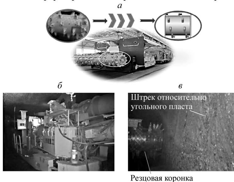
Рис. 13. Использование проходческого комбайна с резцовой коронкой в угольной шахте
