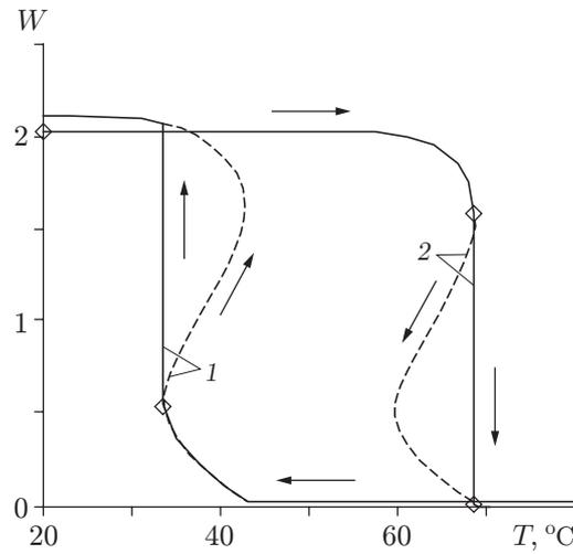
Рис. 5. Межфазный гистерезис сферического хлопающего купола в термомеханическом цикле ( $\varepsilon = 0,01$ ,  $p = 0,002$ ):
