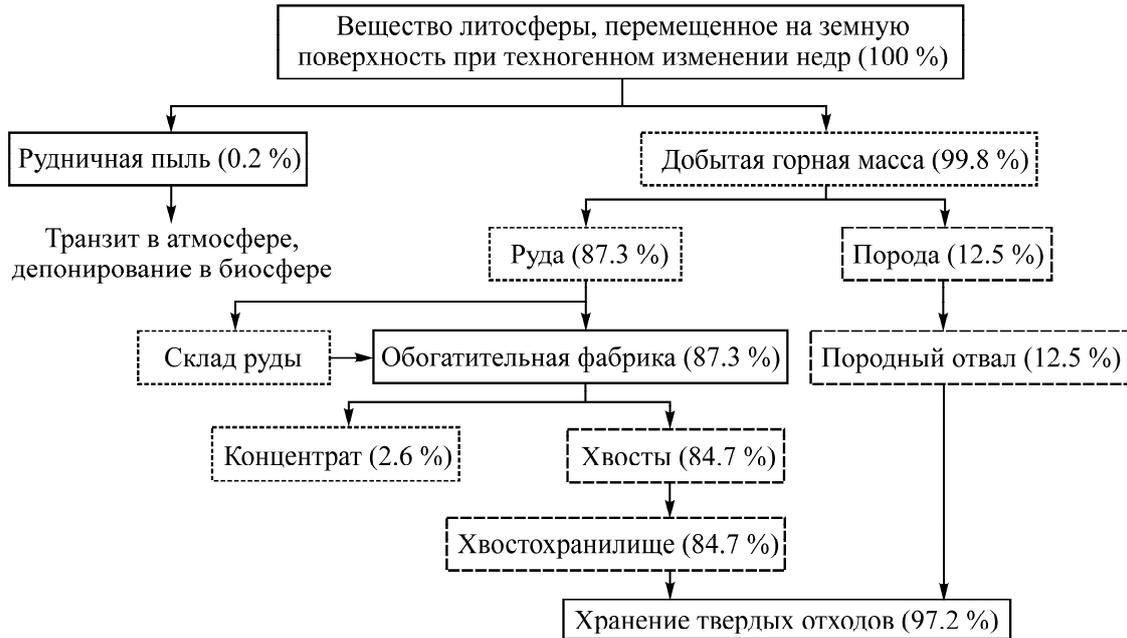
Рис. 2. Усредненный баланс твердого вещества горно-обогатительного производства при подземной разработке жильных месторождений золота
