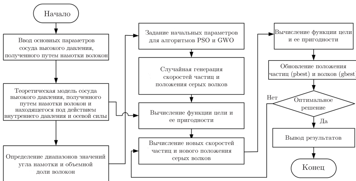
Рис. 2. Алгоритм вычислений с использованием гибридного метода PSO–GWO
