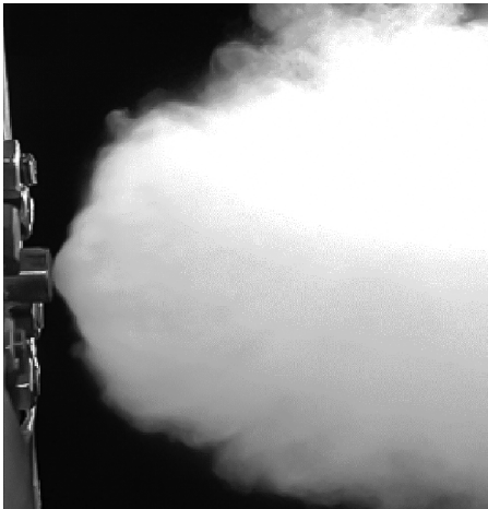
Рис. 3. Фотография струи вскипающей воды в процессе истечения для начальных условий сверхкритического состояния при T_0 = 650 К [2].
