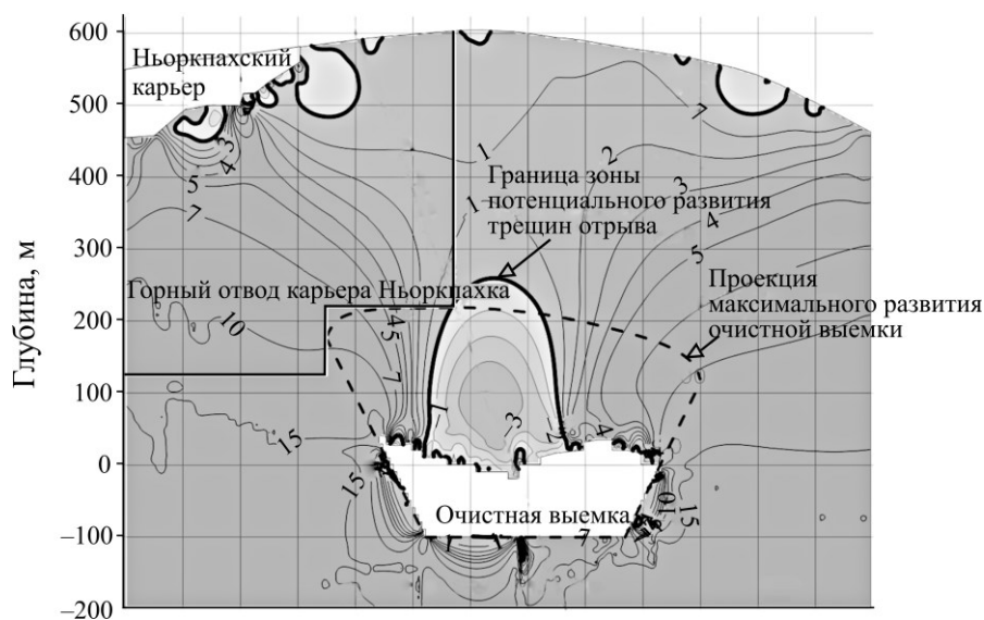
Рис. 1. Распределение напряжений \sigma_{\min} (МПа) в окрестности очистного пространства в разрезе по простиранию рудной залежи при отработке запасов месторождения Олений ручей
