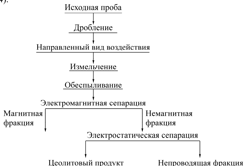
Рис. 4. Схема переработки цеолитсодержащих продуктов Шивиртуйского и Талан-Гозагорского месторождений
