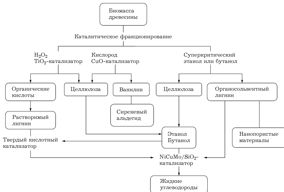
Рис. 7. Схема “зеленой” биорефайнери древесной биомассы, основанной на интегрированной переработке полисахаридов и лигнина.
