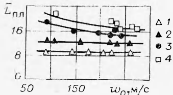
Рис. 2. Расстояние до точки воспламенения при различной начальной скорости струи; установка 3, d_0 = 132 мм.
