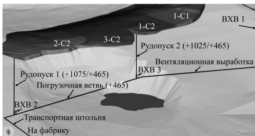
Рис. 5. Схема вскрытия с использованием железнодорожного транспорта: 2-С2 — 2-е рудное тело, категория разновидности С2; 1-С2 — 1-е рудное тело, категория разновидности С2 и т. д.
