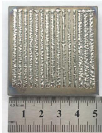
Рис. 1. Поверхность единичных треков при лазерной наплавке порошковой смеси Ti-6Al-4V при различных режимах лазерного воздействия ( $t = 400 \text{ мкм}$ ):
