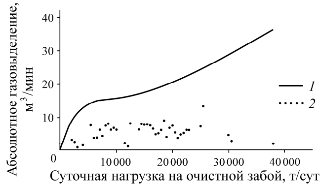
Рис. 1. Расчетные (1) и фактические (2) значения метановыделения в лаве № 5203 шахты “Котинская”
