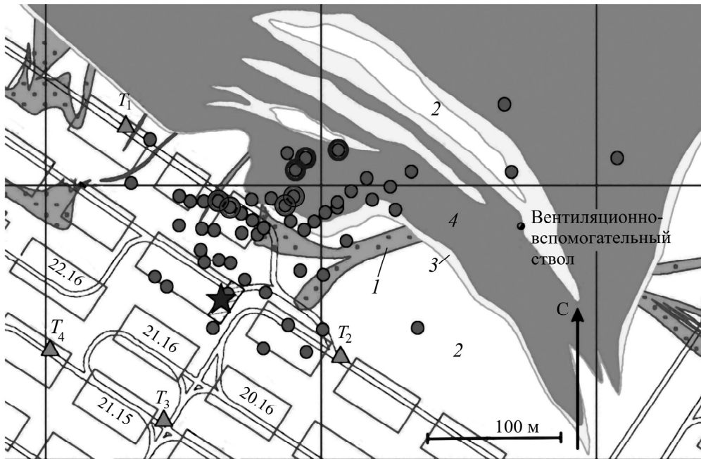
Рис. 1. Очаги сейсмических событий (залитые кружки), зарегистрированных после короткозамедленного взрыва в камере 21.17сз 12.11.2022, на плане шахтного поля (гор. –125 м). Треугольники — измерительные пункты T_1 – T_4 , оборудованные акселерометрами, звезда — область подрыва в камере; 1 — тело разлома; 2 — железорудная свита; 3 — безрудные или слаборудные кварциты; 4 — сланцевая свита; светло-серыми и темно-серыми кругами отмечены две группы событий с высоким коэффициентом корреляции
